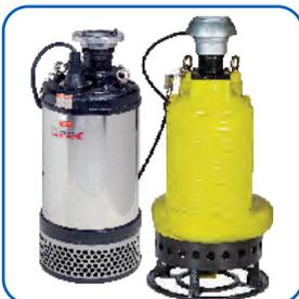
Especialmente diseñadas para tareas de agotamiento de aguas limpias o sucias. Muy versatil y de diseño compacto, con doble carcasa que garantiza la refrigeración del motor por medio del fluido bombeado. Conexión de descarga desde 1" a 4". Carcasa externa en Acero inoxidable 304. Eje Acero inoxidable 410. Doble sello mecánico Carbon-Cerámica / SiC-SiC-Vitón. Carcasa bomba con difusor en goma NBR. Motores eléctricos con aislación Clase F, IP68.
