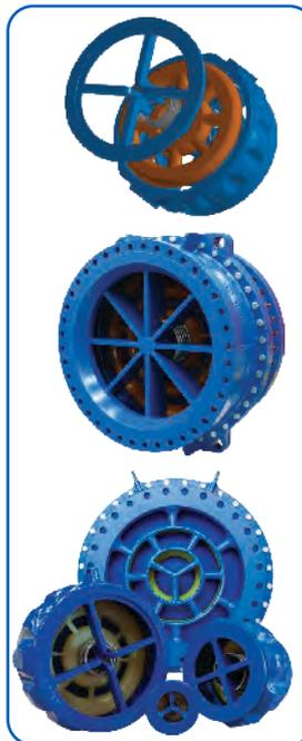
Válvula de retención de cierre rápido de desplazamiento axial y baja inercia, wafer para instalación entre Bridas bajo Norma ISO 2531 PN 10, con tiempo de cierre de 0.01 a 0.05 segundos.
