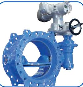
Válvulas de mariposa bridada, doble excéntrica, con cuerpo y disco en Fundición Nodular GGG40, eje de acero inoxidable, anillo de sello de elastómero, operación mediante caja de engranajes. Recubrimiento epóxico interno y externo. Bridas según DIN.
