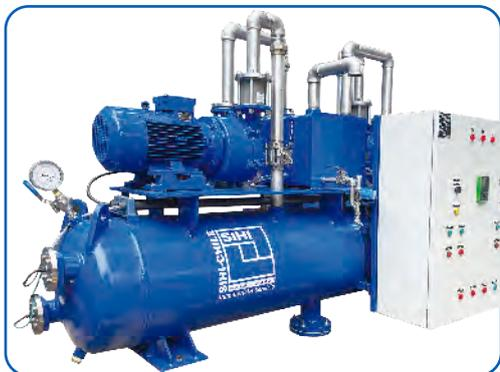
La central de vacío automática desarrollada por SIHI CHILE se ha diseñado para realizar el cebado automático de plantas elevadoras y sistemas de punteras evacuando continuamente el aire que se encuentra en manifold de succión y bombas centrífugas, que impulsan aguas limpias o ligeramente contaminadas.
