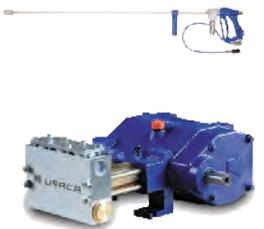
Las bombas de pistones de alta presión URACA están diseñadas y construidas para servicio industrial pesado. Las bombas están compuestas por una unidad motriz lubricada por aceite que incluye caja reductora de velocidad y el cabezal hidráulico compuesto de 3 pistones, caja prensa estopas y válvulas. Junto con cada bomba se pueden suministrar todos los dispositivos de seguridad y protección y accesorios requeridos.
