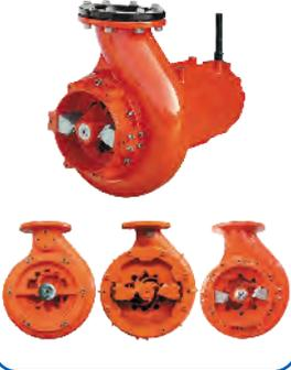
Estas bombas provistas de rodetes multicanal abiertos a amplios pasajes libres y doble triturador en aspiración, están indicadas para usos particularmente pesados en los que se requiere una trituración previa de las sustancias sólidas o fibrosas contenidas en el líquido que se va a bombear.
